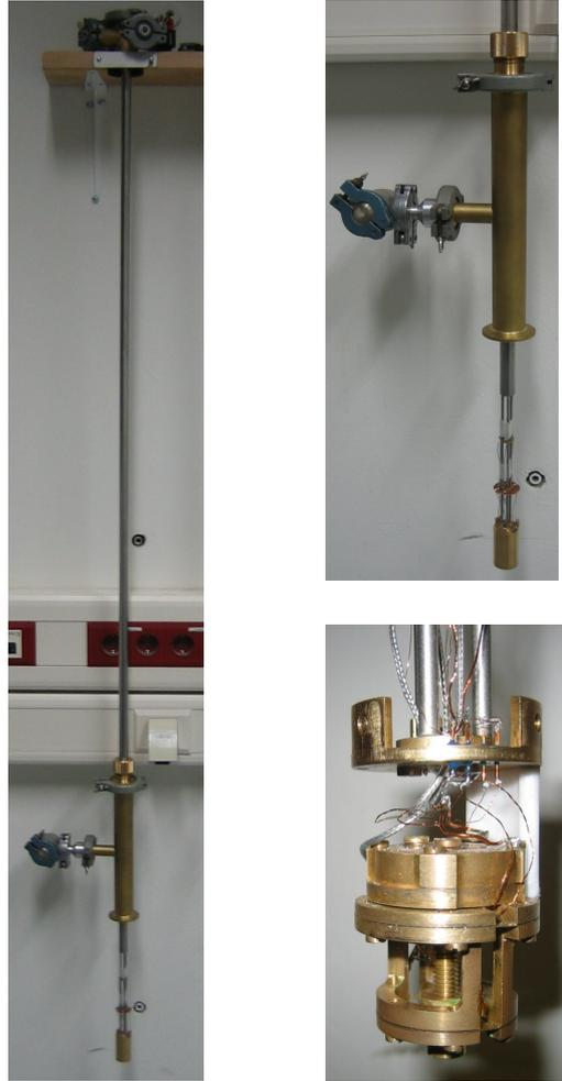
**Abbildung 3.2:** Foto des neuen Messstabes (links), einer Vergrößerung des unteren Stabteils (rechts oben) und der neuen Messzelle (rechts unten).
